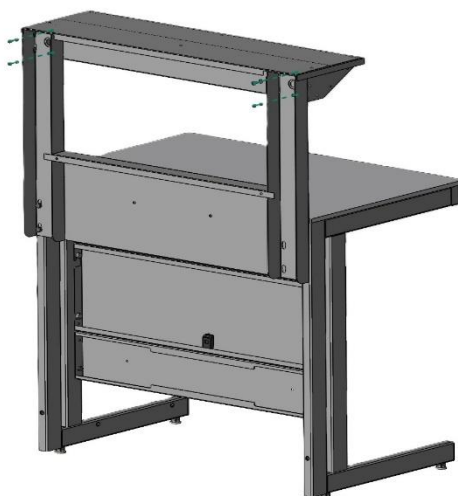
Рис. 4. Фиксация полки надстройки
